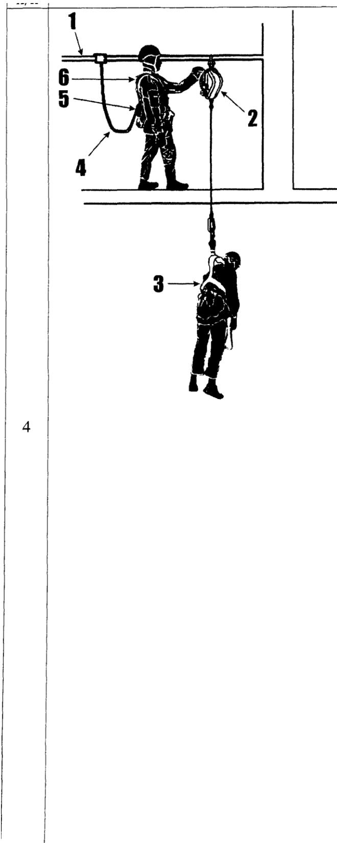
Система спасения и эвакуации, использующая средства защиты втягивающего типа со встроенной лебедкой.
